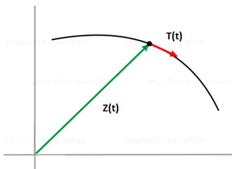
上圖顯示，綠色的位置向量  $Z(t)$  以整個平面的坐標原點作為起點，不論  $t$  的值如何變化， $Z(t)$  都總以這個原點作為起點；紅色的單位切向量  $T(t)$  則
